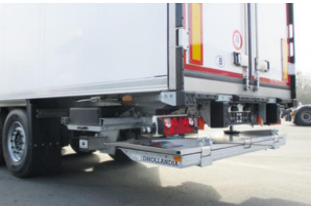
La DH-SM(R).20 è il **modello di sponda retrattile più venduto nella gamma di media capacità**. Questa sponda versatile consente di movimentare diverse tipologie di carichi, inclusi i pallet, fino a 2.000 kg.
